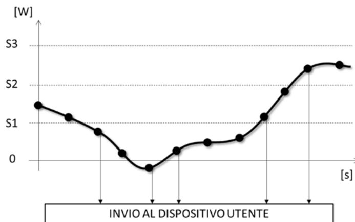
Figura 1 – Invio dell'ultimo campione di potenza attiva istantanea registrato dal misuratore intelligente 2G ogni secondo per mezzo di un sistema a attraversamento di soglie
