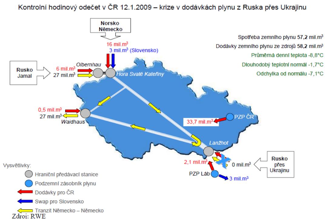
Obrázek 3 Schéma dodávek a toku plynu dne 12. ledna 2009, kdy bylo dosaženo maximální spotřeby
